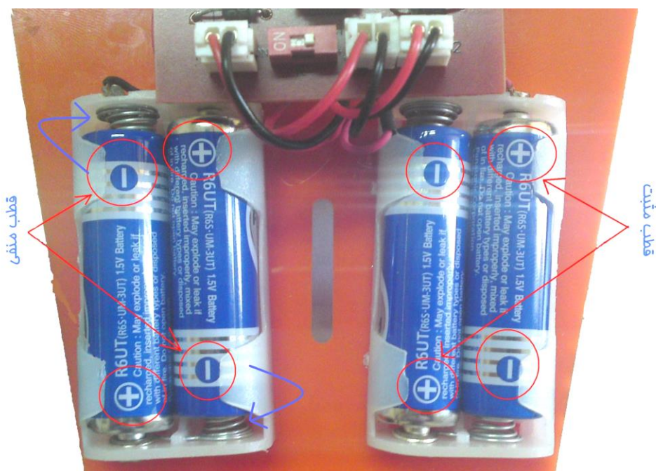
تصویر شماره ۱۹ : نحوه قرار دادن باطری‌ها در جاباطری‌ها (قطب منفی هر باطری سمت فنر جاباطری)
